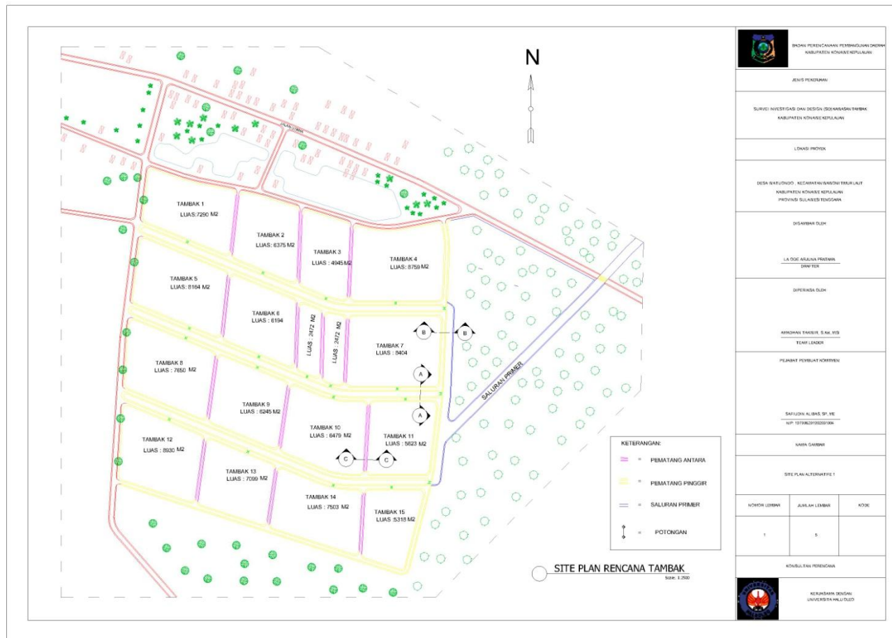
Gambar 6.6. Desain site plan tambak alternatif 3 dengan melakukan perubahan aliran pada saluran primer.
