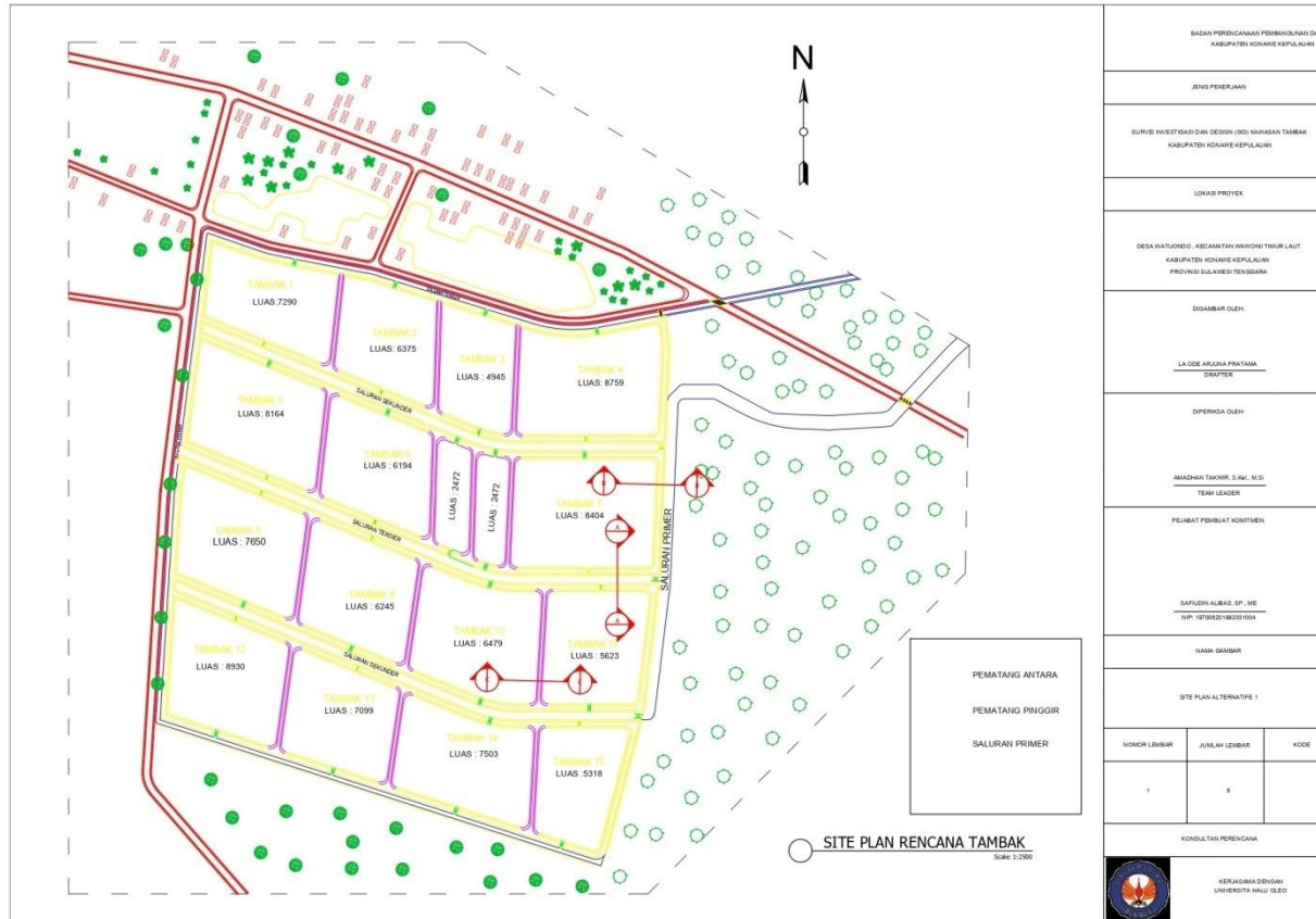
Gambar 6.5. Desain site plan alternatif 2 dengan menggunakan saluran tersier / outlet.
